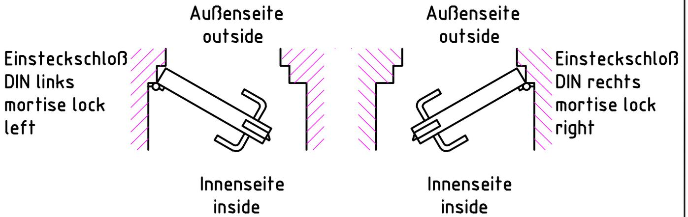
Tür Drehrichtung DIN rechts/links und ein- oder auswärts für Kastenschlösser
